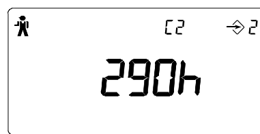
Compteur d'alarme sur-débit US : C2 (heures)
